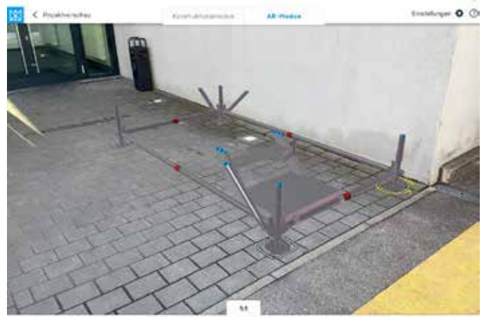
İskele yapısının parçalarını görselleştirmek için kesme fonksiyonlu (sınır kutusu) artırılmış gerçeklik modu
