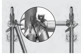
Üst görünüşten, sol yatay bir çapraz desteğin kama başı sol kenara işaret eder.
